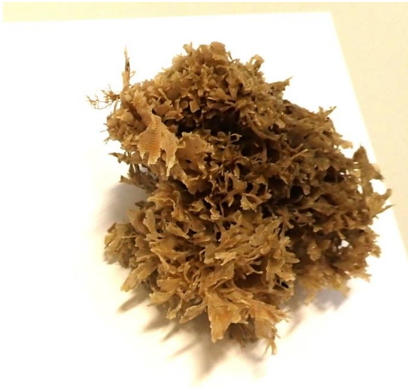
Kuva A. Liuskasammaleläin Conopeum chesapeakensis -kasvustoa Olkiluodon ydinvoimalan putkistosta. Kuva: Teollisuuden Voima Oyj.
